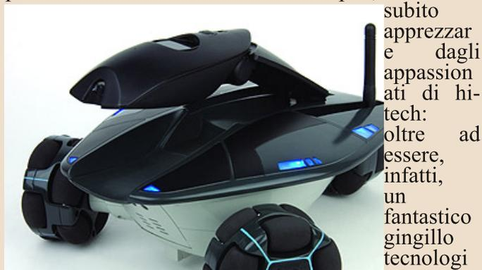
Grazie a dei particolari sensori audio e ad una telecamera orientabile a risoluzione VGA, il robottino con le ruote è in grado di catturare i suoni di un determinato ambiente e di riprendere ciò che avviene all'interno, consentendo così di avere un controllo completo della propria proprietà in qualsiasi momento e ovunque ci si trovi, in qualsiasi parte del mondo.
