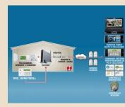
sistema videocontrollo propsoto da Abb consente all'utente di visionare da remoto via internet, oppure attraverso telefono cellulare o un qualsiasi personal computer, immagini in diretta o in differita
