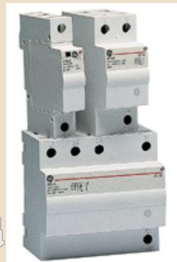
Gli S.P.D. Tipo 1 (forma d'onda di prova 10/350µs) sono prescritti quando è necessario ridurre il rischio di incendi all'interno della struttura, oppure sovratensioni sugli impianti interni ed esterni alla struttura per fulminazione diretta. Gli S.P.D. Tipo 2 sono invece richiesti per la riduzione del rischio di danni provocati da fulminazione
